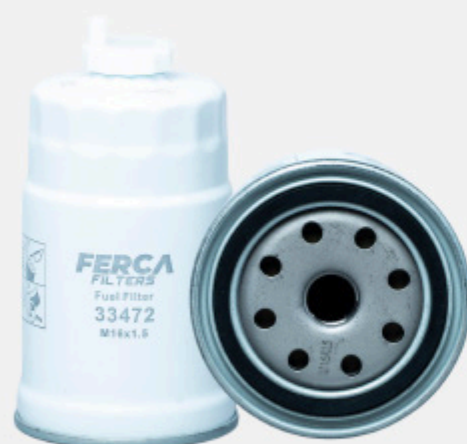
COD. 33472 Rosca: M16x1.5 FORD CARGO 815 JAC HFC1061 / IVECO DAILY Altura: 158mm Diametro exterior: 80,5mm
