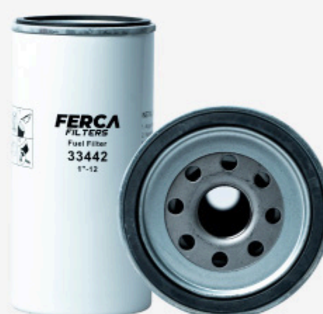
COD. 33442 Rosca: 1"-12 KODIAK 7000-7500-8500 VOLKSWAGEN Altura: 192mm Diametro exterior: 93,6mm
